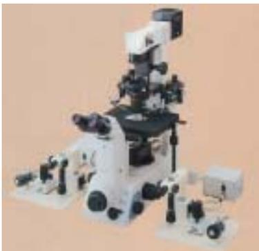
**Fig. 1:** Intero sistema per la microiniezione: invertoscopo e strumenti di micromanipolazione.
